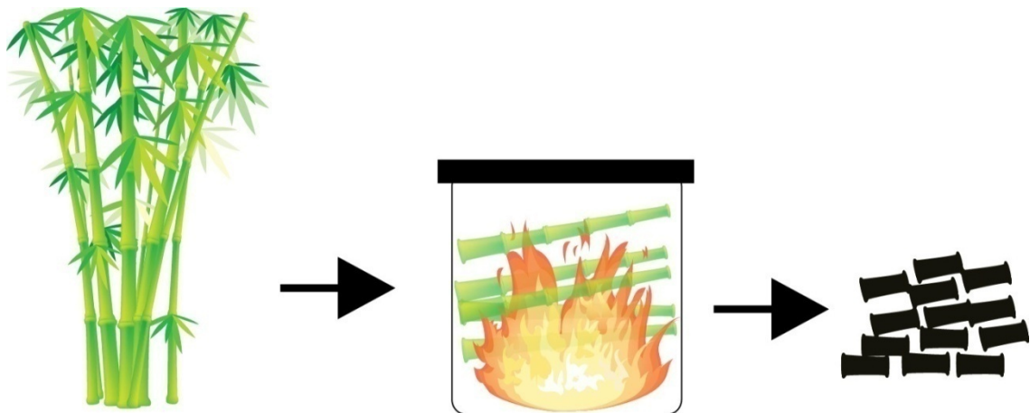
รูปที่ 2 อธิบายวิธีการทำถ่านเชื้อเพลิงจากไม้ไผ่
